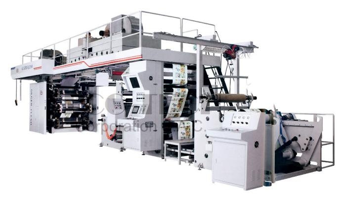
Principales parámetros técnicos Impresión de materiales: PP/BOPP / PET / PVC / PE / NY / papel Exactitud de trama: ± 0,1 mm vertical; ± 0,1 mm longitudinal Impresión a color: 4 colores, 6 colores, 8 colores Ancho de impresión: 800 ~ 2200mm Velocidad de impresión: 200m/min
